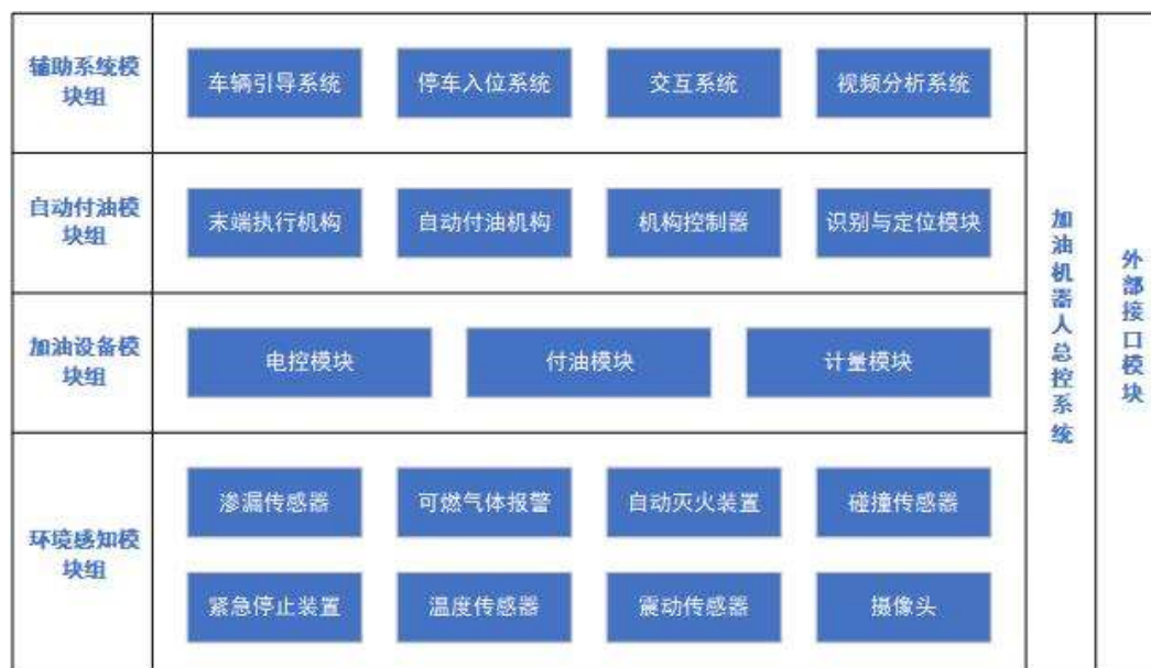
图1 加油机器人系统组成图
