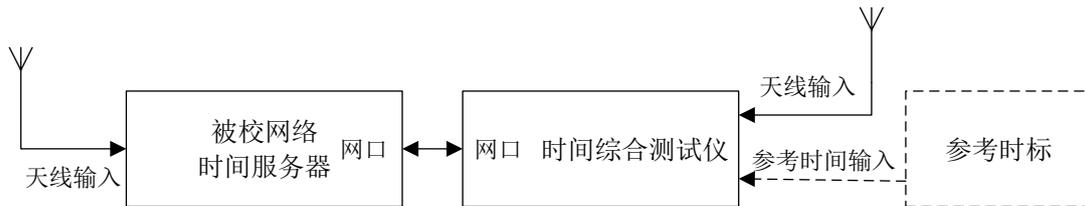
图 6 PTP 同步偏差校准示意图
