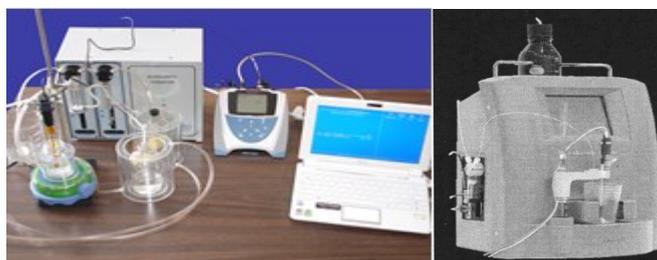
图 1 电位滴定法的海水总碱度分析仪
