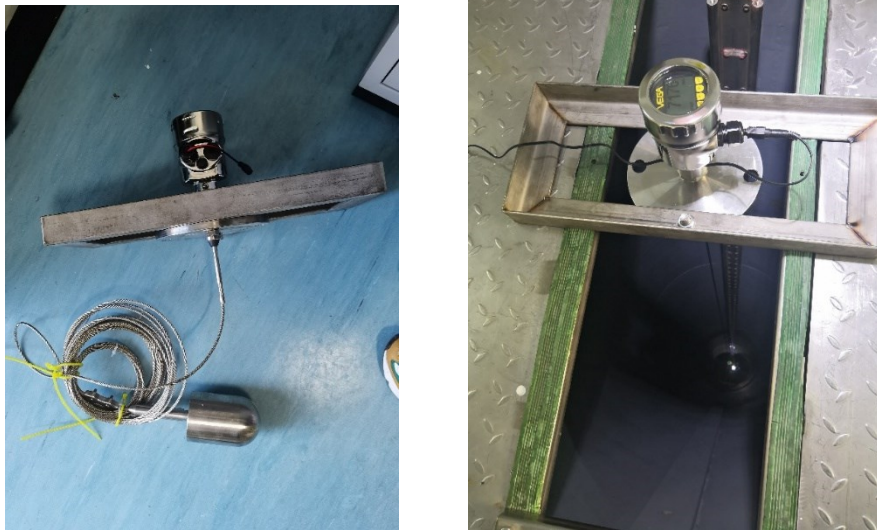
图 3 利用水塔校准装置校准导波式雷达验潮仪验证试验
