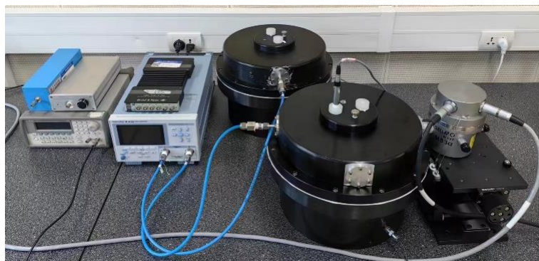
图 3.2 耦合腔比较法次声传感器校准装置
