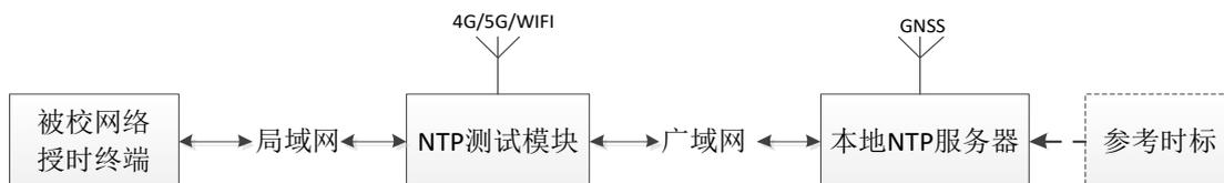
图 4 NTP 测试模块校准时间偏差示意图
