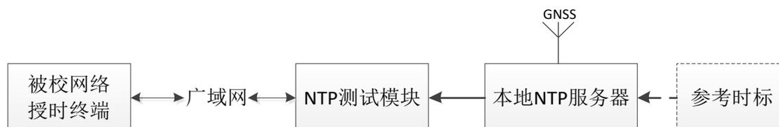
图 2 NTP 测试模块校准时间偏差示意图
