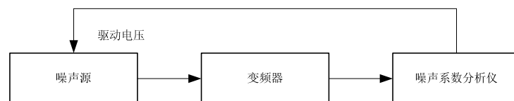
图 8 Y 系数法噪声系数校准连接示意图
