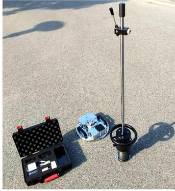
图1 手持式落锤弯沉仪实物图
