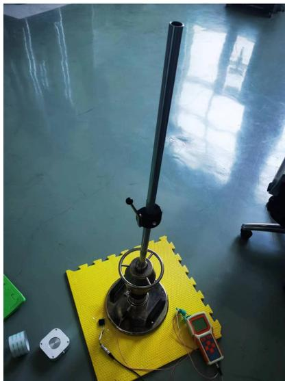
图 4 手持式落锤弯沉仪的重复性测量示意图
