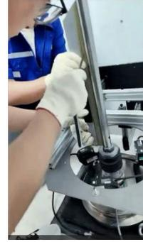
图 7 导向杆直线度校准
