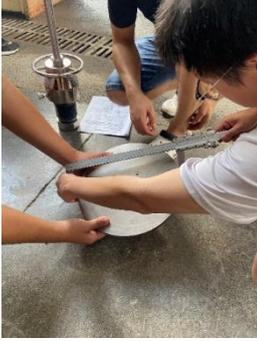
图 5 承载盘直径校准
