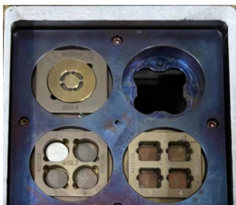
图 5 耐驰闪光法导热仪样品腔
